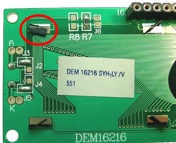
Bild 17: Umbiegen einer Befestigungslasche des Displays.
