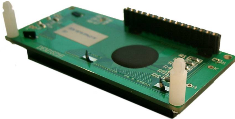
Bild 18: Abstandshalter des Displays
