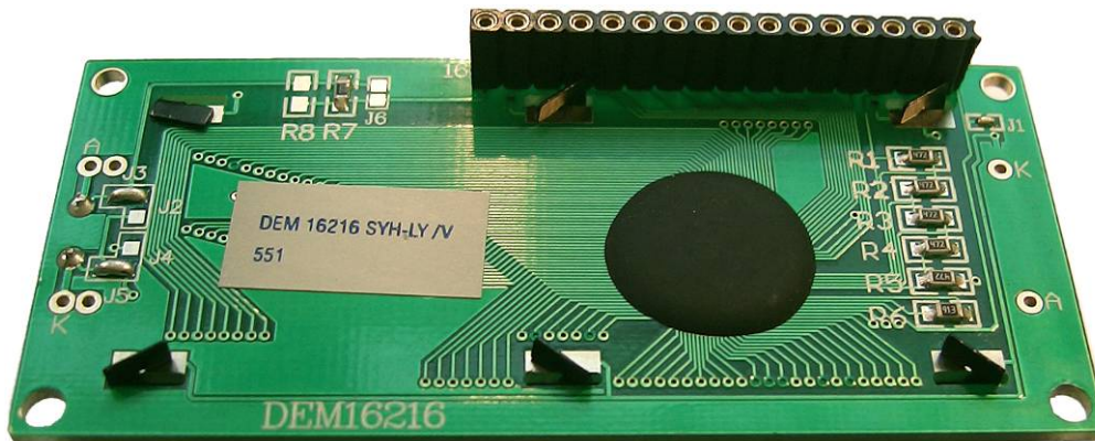
Bild 16: Buchsenleiste an Display.
